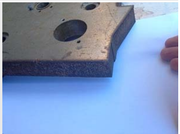
Резка нержавеющей стали толщиной 32 мм на установке
